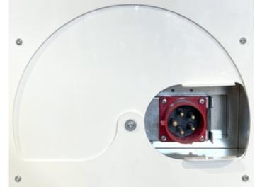
Beim HEZ22/3 sind die drei Möglichkeiten 16 A/230V ~ (max. 4 kW), 16 A/400V 3N~ (max. 11 kW) und 32 A/400V 3N~ (max. 22 kW). Wählen Sie den richtigen Anschluss für die Stromversorgung über die drehbare Blende an der Geräteseite aus und schließen Sie die Stromversorgungsleitung an die mobile Elektroheizzentrale an.
